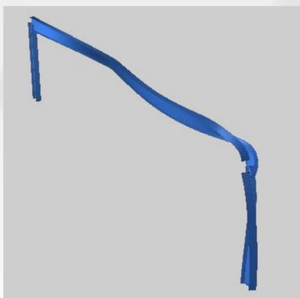
Durch die Stabilisierung des Binders durch Dachpfetten werden nur lokale Eigenformen an den Rahmenecken erzeugt.
