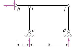
Aus der Gleichgewichtsbedingung  $\sum H = 0$  am rechten Teilsystem folgt, dass die Normalkraft im Bereich *h-i-j* gleich null ist.
