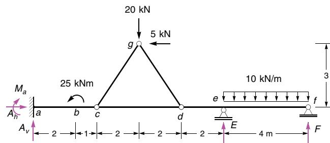
Da nur das Auflager im Punkt  $a$  horizontal fest ist, folgt die Auflagerkraft  $A_h$  aus der Bedingung  $\sum H = 0$  am Gesamtsystem mit  $A_h = 5 \text{ kN}$ . Im Bereich  $d - e - f$  ist die Normalkraft gleich null, da keine horizontalen Kräfte wirken. Die weitere Berechnung erfolgt entgegen der Reihenfolge des Aufbaus.
