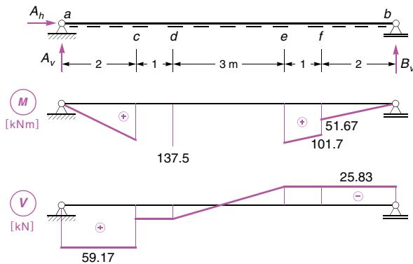
Grundlage der Lösung sind die differenziellen Beziehungen zwischen den Zustandslinien und der äußeren Belastung.
