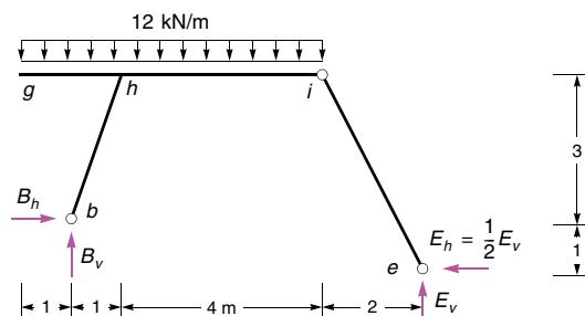
Der Stab  $i - e$  ist ein Pendelstab, darum wirkt die resultierende Auflagerkraft im Punkt  $e$  in Richtung der Stabachse.
