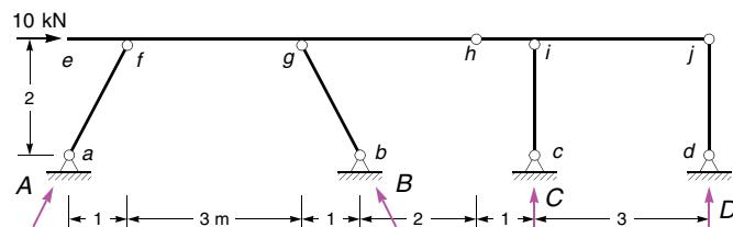
Alle Auflagerkräfte wirken in Richtung der Pendelstäbe. Damit folgt das Verhältnis der Komponenten der Auflagerkräfte in den Punkten *a* und *b* mit:  $A_v = 2A_h$  und  $B_v = 2B_h$ .
