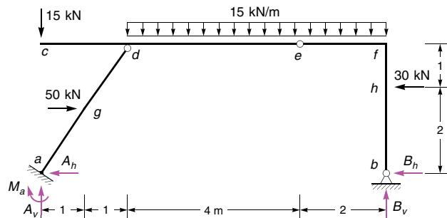
Der Kragträger  $a - d$  ist statisch bestimmt und unverschieblich und wird zuerst eingebaut. Die beiden Teilsysteme  $c - e$  und  $e - b$  bilden einen Dreigelenkrahmen.
